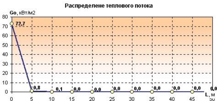
Рис. 6. Распределение теплового потока при горении бензина и ДТ через горловину подземной емкости
